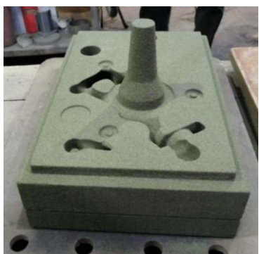
Печать песчано-полимерной формы для литья
