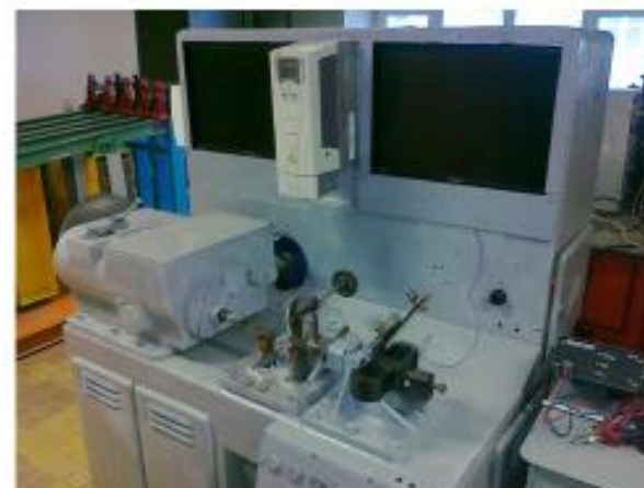
Установка для имитации термомеханических циклов в процессе сварки и термообработки
