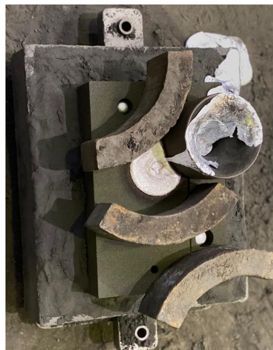
Гравитационное литье в песчано- полимерную форму и извлечение отливки
