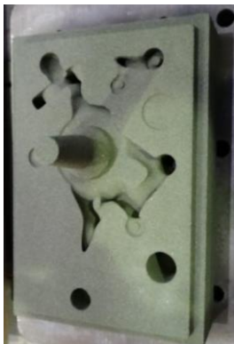
Печать песчано-полимерной формы для литья
