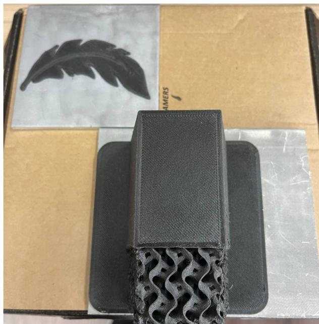
Стрингер. Соединение металл (пластина Д16АТ) и углепластик (РА12-СF) с промежуточным слоем из РА11 методом прямой печати
