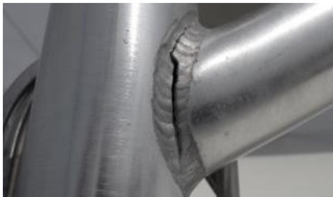
Проблема сварных швов сплавов Al-Zn-Mg (Cu)
