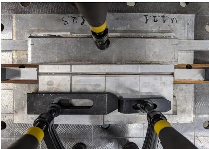
Схема закрепления образцов для сварки
