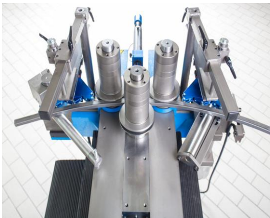
Гибка профиля и трубы на станке с ЧПУ
