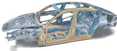
Серым цветом окрашены алюминиевые элементы, коричневым — элементы, изготовленные из высокопрочной легированной стали, и голубым — элементы из обычной стали
