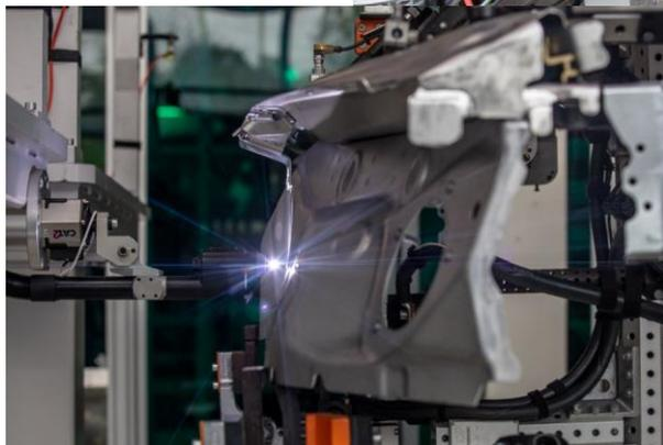
Технология активной плазмы **Acerios\*** позволяет осуществлять локальную (зонную) очистку поверхностей деталей в промышленности за счет быстрого и эффективного удаления органических загрязнений и пленочных примесей.
