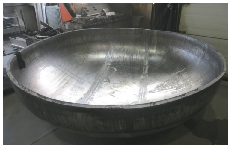
Днище толщиной 35 мм
