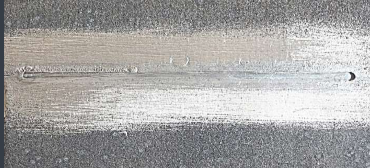
Внешний вид сварных соединений пластин сплава AlSi10Mg толщиной 3 мм с лицевой и обратной стороны приведен
