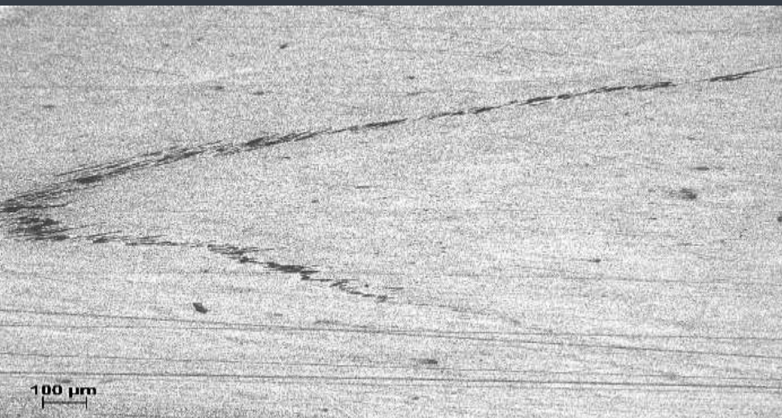
Разрушение сварных образцов соединений при испытании на статическое растяжение
