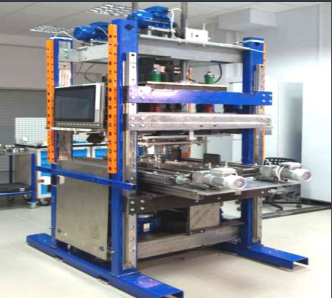
Опытная установка для сварки трением с перемещиванием листовых заготовок
