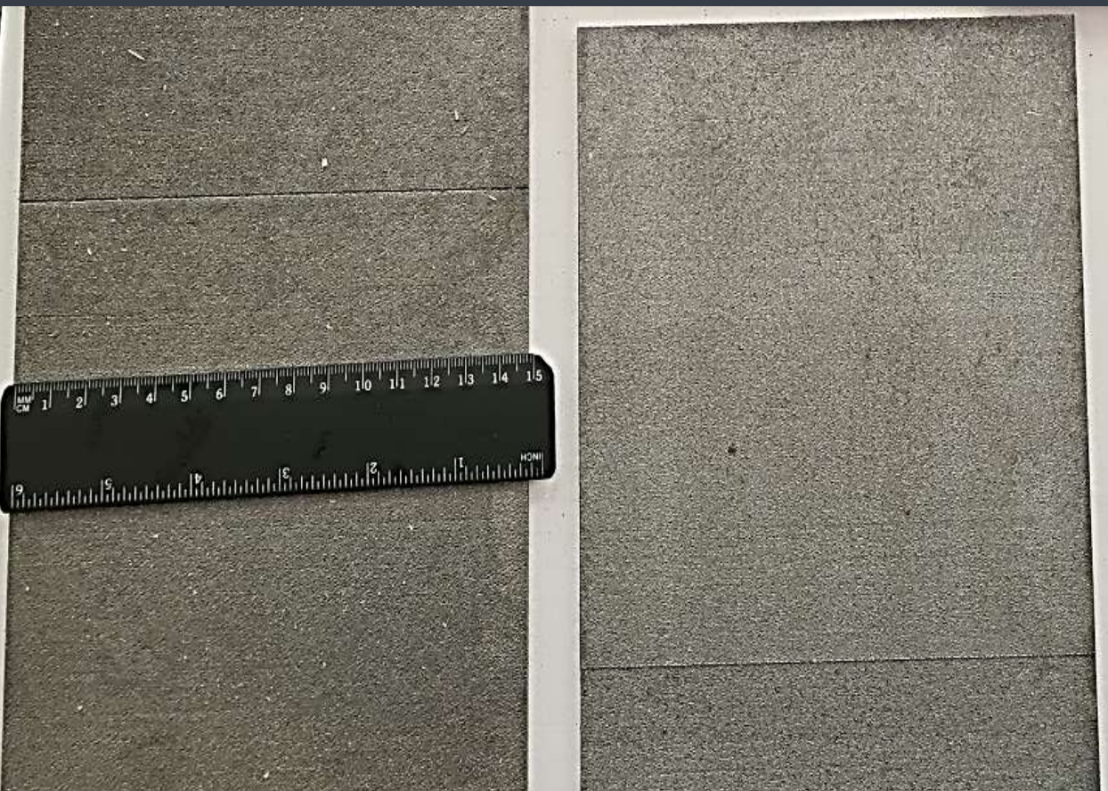
Пластины толщиной 3 мм из сплава AlSi10Mg, выращенные селективным лазерным плавлением
