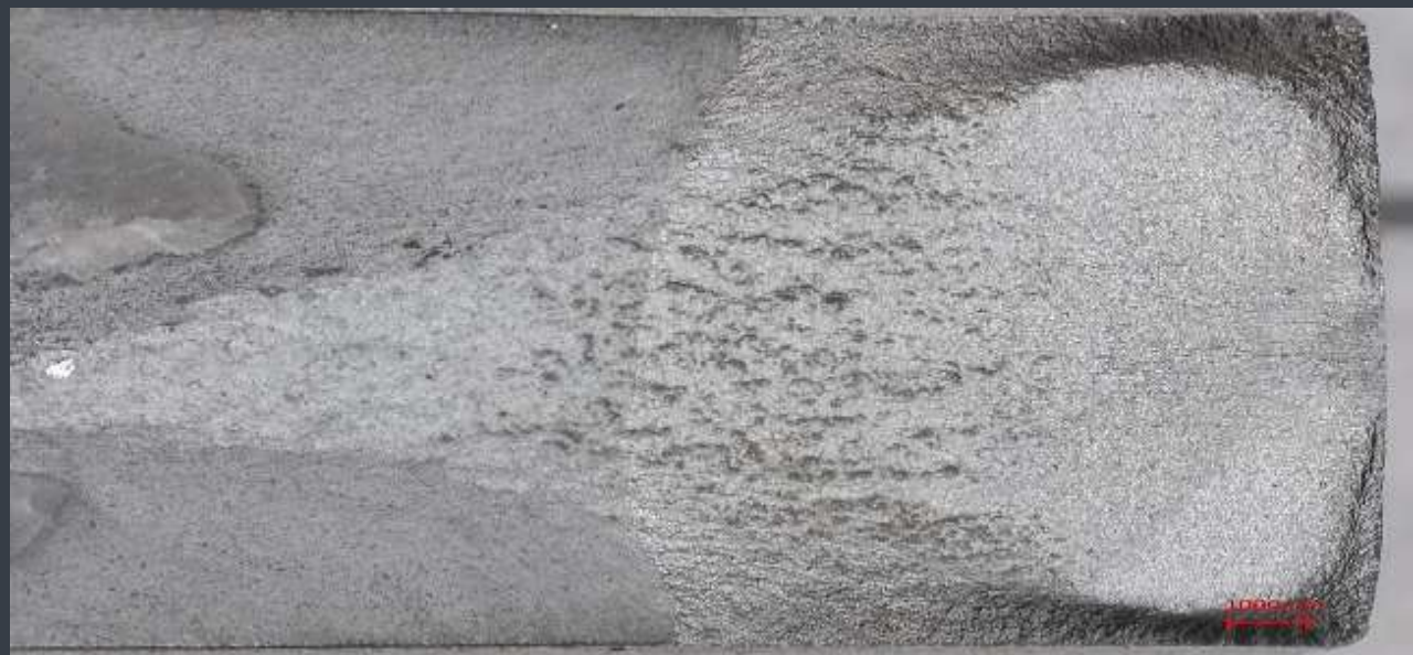
Микроструктура металла шва сварного соединения №1 с дефектом в виде протяженной оксидной пленки (слева) и поверхность разрушения образца (справа)
