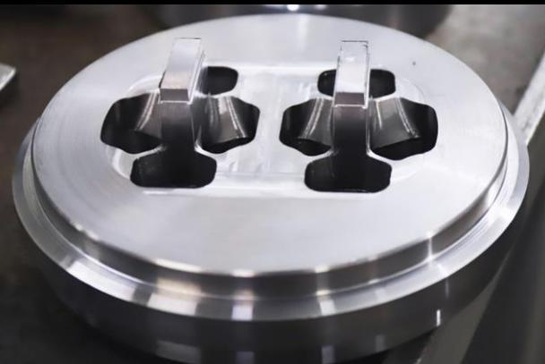
Одним из обязательных условий получения качественного алюминиевого профиля является применение высокоточного и надёжного прессового инструмента (матриц для экструзии). Матрицы можно изготавливать для неограниченного количества видов профилей, единственным требованием к профилю является его **технологичность** с точки зрения прессования.
